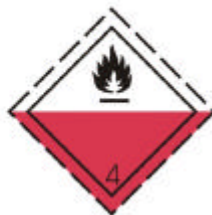
(No. 4.2) División 4.2 Sustancias que presentan riesgos de combustión espontánea Símbolo (llama): negro; Fondo: blanco en la mitad superior, rojo en la mitad inferior Cifra "4" en el ángulo inferior
