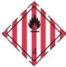
(No. 4.1) División 4.1 Sólidos inflamables Símbolo (llama): negro; Fondo: blanco con siete frangas rojas verticales; Cifra "4" en el ángulo inferior
